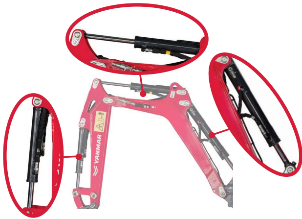
Siłowniki zamontowane nad wysięgnikiem
